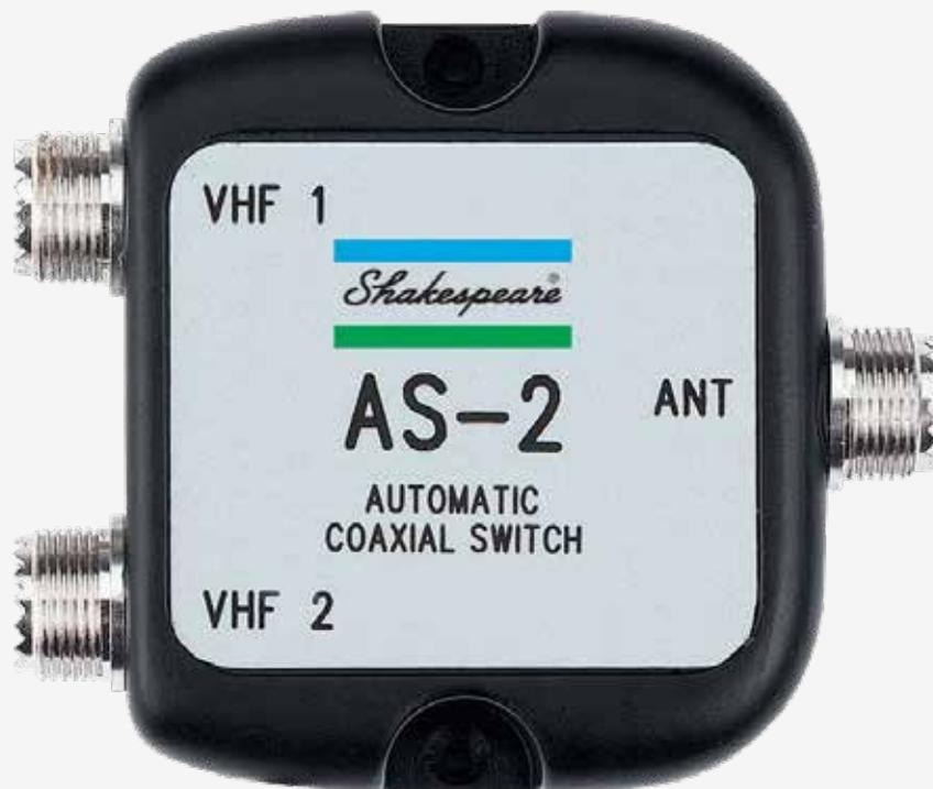
Este interruptor automático alterna dos radios a una antena. Cuando conecta el micrófono a uno de los radios, cambia la antena automáticamente. El radio permanece bloqueado en la antena hasta que el interruptor automático detecta una transmisión del otro radio. ¡Fácil!
