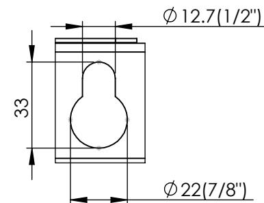
1. Fabricado con lámina de acero calibre 14 y 16.
