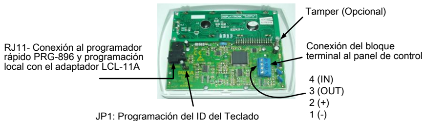
Figura 33. Parte posterior del Teclado LCD sin tapa
