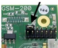
Figura 43. Jumper para seleccionar la frecuencia a 1900 MHz
