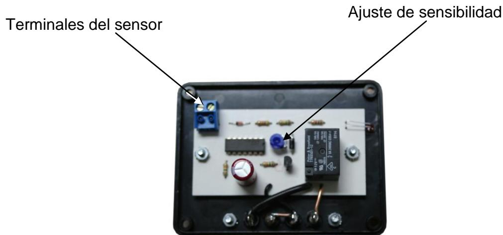
El cable del sensor debe salir por la perforación de 1/8 en la parte baja del gabinete
