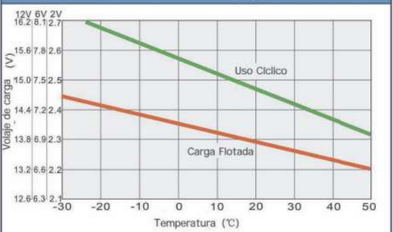
Relación entre la tensión de carga y la temperatura
