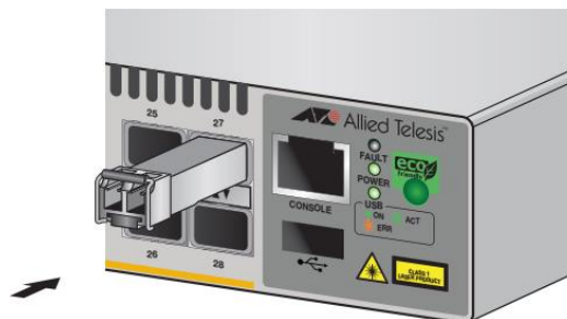
Figura 27. Inserción del transceptor en una ranura SFP
