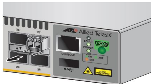
Figura 29. Extracción de un transceptor después de jalar la manija
