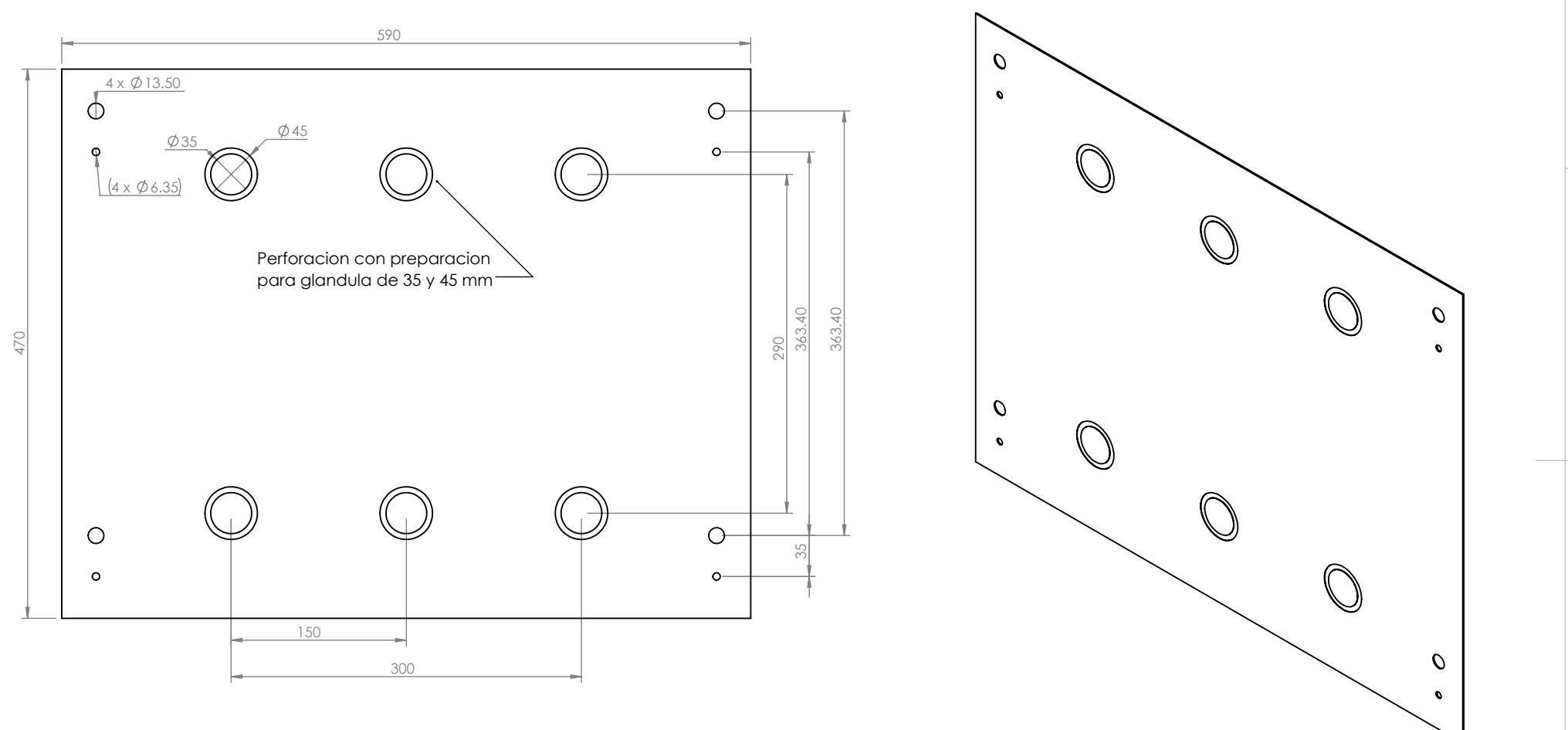
1. Fabricado con lamina rolada en frio calibre 18.
