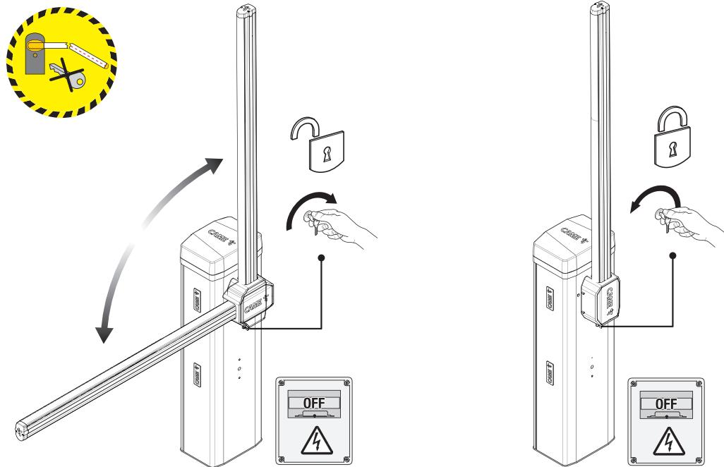
⚠ Es necesario que los muelles de equilibrado no estén en tensión (mástil en posición vertical) para poder efectuar las operaciones de mantenimiento de la barrera.
