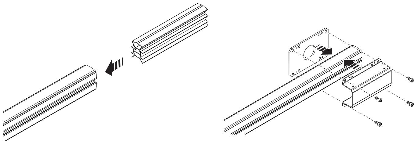
Fijar el mástil a la placa de fijación.
