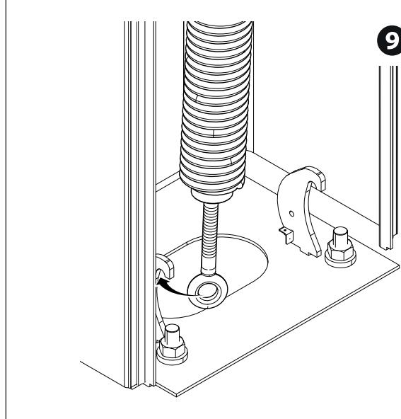
Lubricar el muelle cuando está completamente extendido.
