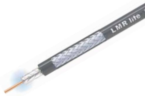
• **LMR-LW240** es un cable coaxial liviano de baja pérdida que emplea un blindaje de aluminio trenzado, en lugar del tradicional blindaje de cobre estañado. El LMR-LW240 ha sido diseñado y fabricado con una combinación de propiedades eléctricas, físicas y mecánicas que reducen su peso y costo.
