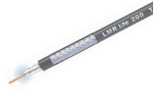
• **LMR-LW200** es un cable coaxial liviano de baja pérdida que emplea un blindaje de aluminio trenzado, en lugar del tradicional blindaje de cobre estañado. El LMR-LW200 ha sido diseñado y fabricado con una combinación de propiedades eléctricas, físicas y mecánicas que reducen su peso y costo.
