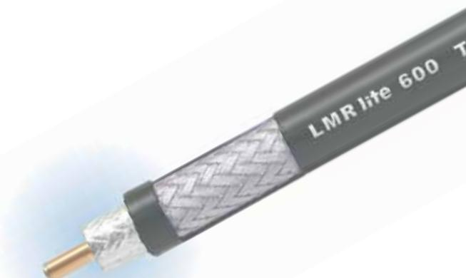
• **LMR-LW600** es una cable coaxial liviano de baja pérdida que emplea un blindaje de aluminio trenzado en lugar del tradicional blindaje de cobre estañado. El LMR-LW600 ha sido diseñado y fabricado con una combinación de propiedades eléctricas, físicas y mecánicas que reducen su peso y costo.
