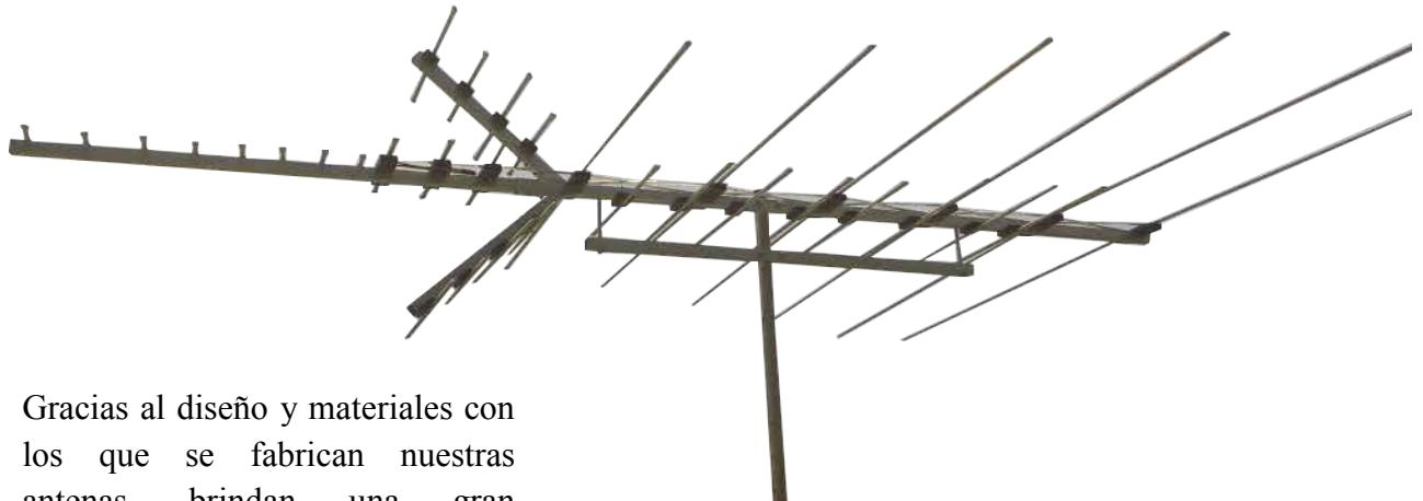
Gracias al diseño y materiales con los que se fabrican nuestras antenas, brindan una gran durabilidad y una excelente eficiencia en ganancia. Están **diseñadas para instalarse en zonas marginales de difícil recepción.** Por estar construidas en 100 % aluminio, presentan ligereza, buena rigidez mecánica y una gran resistencia a la corrosión.
